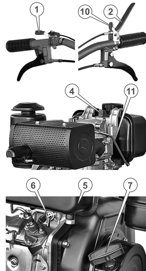
Якщо двигун не вдається завести після 5–7 спроб, треба видалити повітряну пробку з паливопроводу: послабити гайку у верхній частині паливопроводу (11), в місці його з'єднання з форсункою, опустити декомпресор (4) і провертати стартером двигун, поки з-під цієї гайки не потече дизпаливо. Тоді затягнути гайку на форсунці, ще 10–12 разів вхолосту проповернути двигун і знову спробувати його завести.
